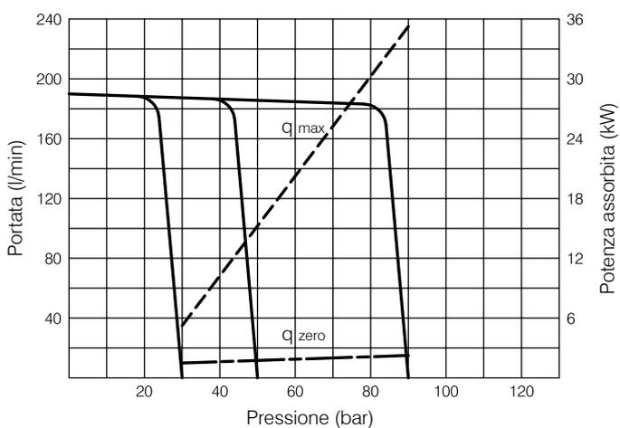
Valori indicativi rilevati su banco prova Berarma, riferiti a 1500 g/min con olio idraulico HM secondo ISO 6743/4, ISO VG 46 secondo ISO 3448, temperatura 40 °C. Distanza fonometro 1 metro e accoppiamento con giunto elastico.
