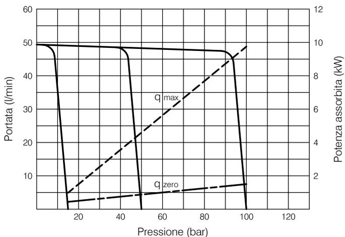
Valori indicativi rilevati su banco prova Berarma, riferiti a 1500 g/min con olio idraulico HM secondo ISO 6743/4, ISO VG 46 secondo ISO 3448, temperatura 40 °C. Distanza fonometro 1 metro e accoppiamento con giunto elastico.
