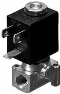
La funzione bistabile è ottenuta mediante un magnete permanente polarizzato. La commutazione avviene inviando un impulso elettrico della durata di almeno 15ms con polarità invertita rispetto all'impulso precedente.
